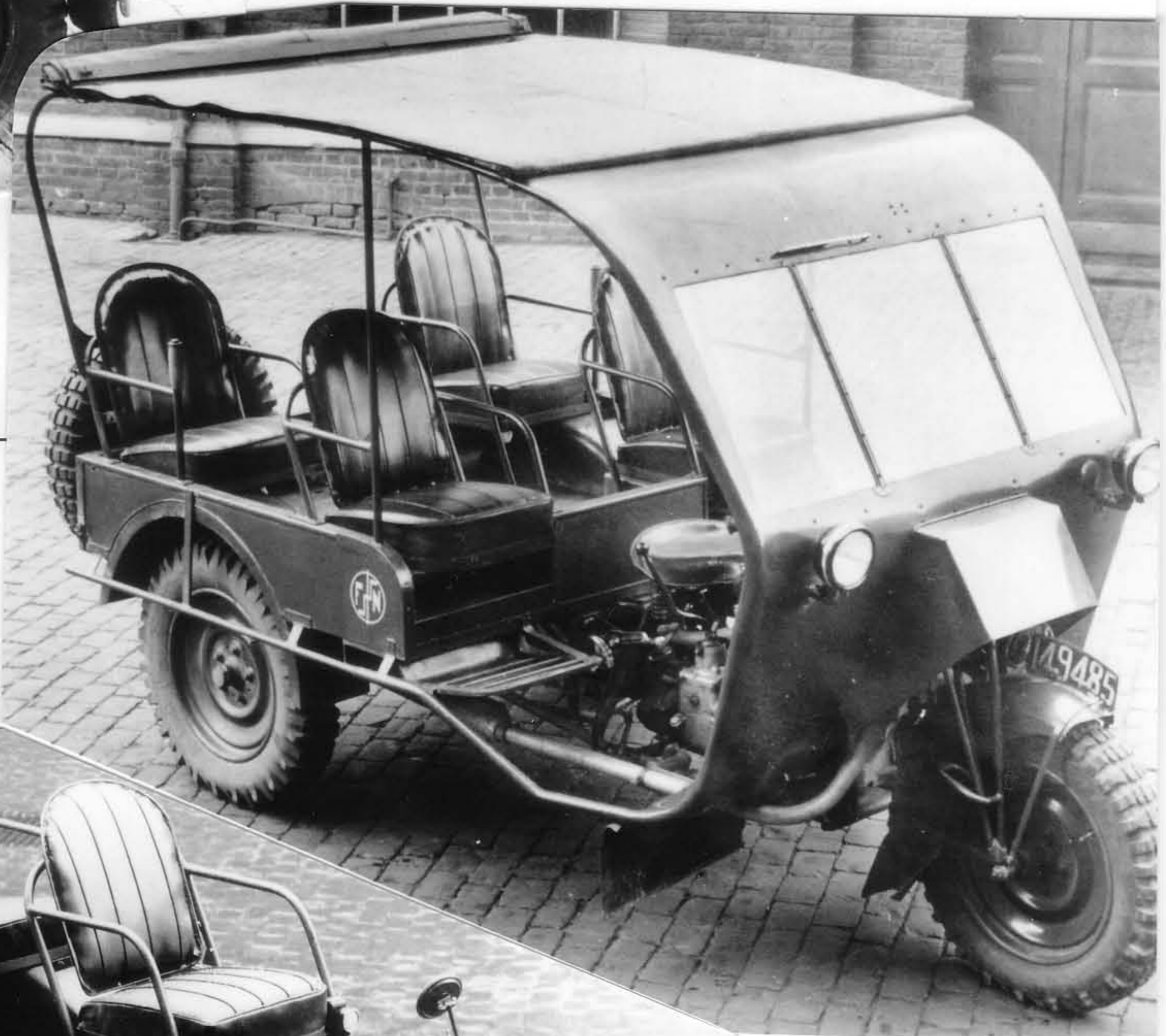
Tricar pour le transport rapide des officiers d'Etat-Major (4 et 5 personnes) et le pilote. Modèles avec et sans toit.
