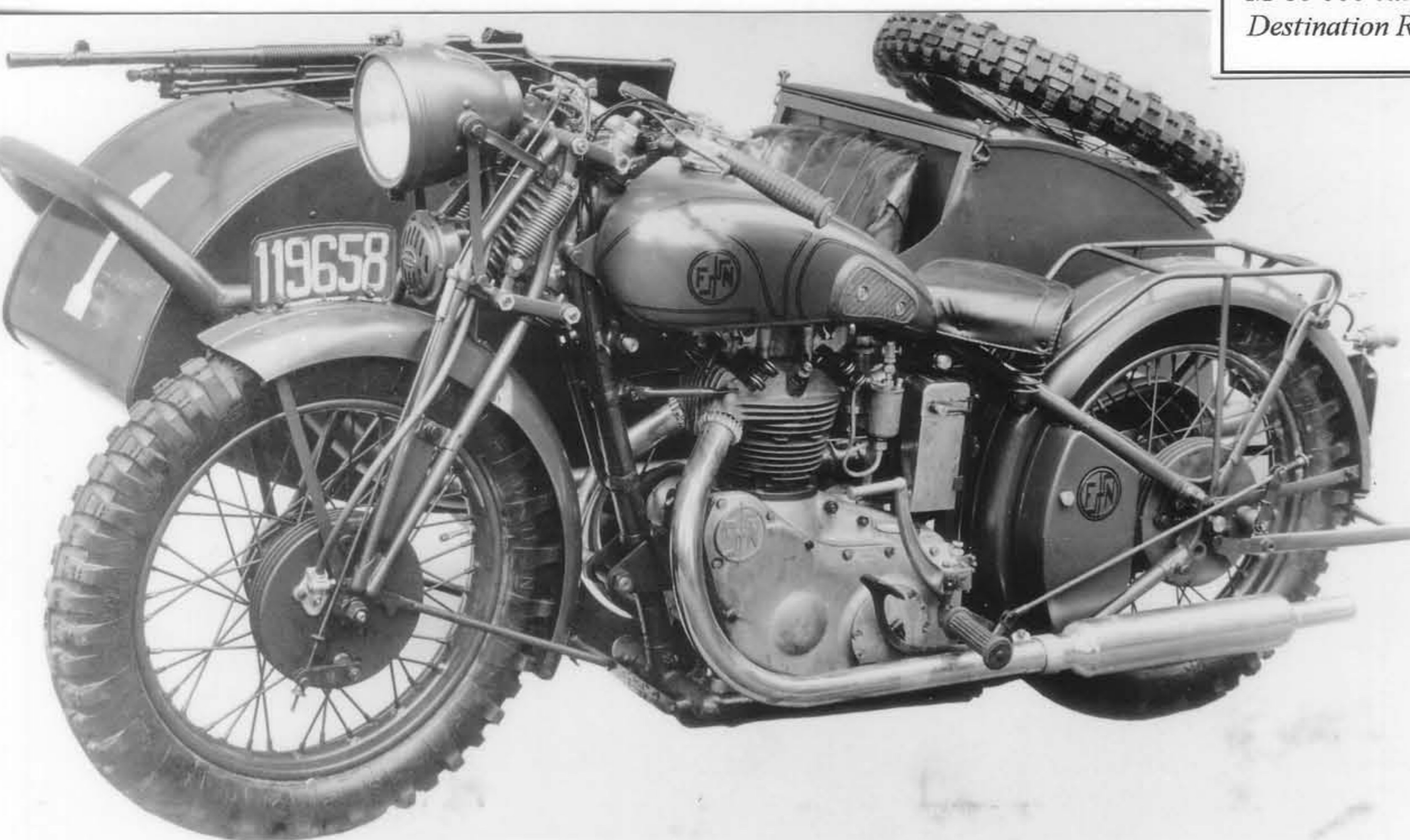
Groupe M-86 side-car avec deux tuyaux d'échappement. FM Browning FN de 7,65 mm monté sur un sup- port avant du side-car. Ce modèle ne fut pas retenu par l'armée belge. (1935)
