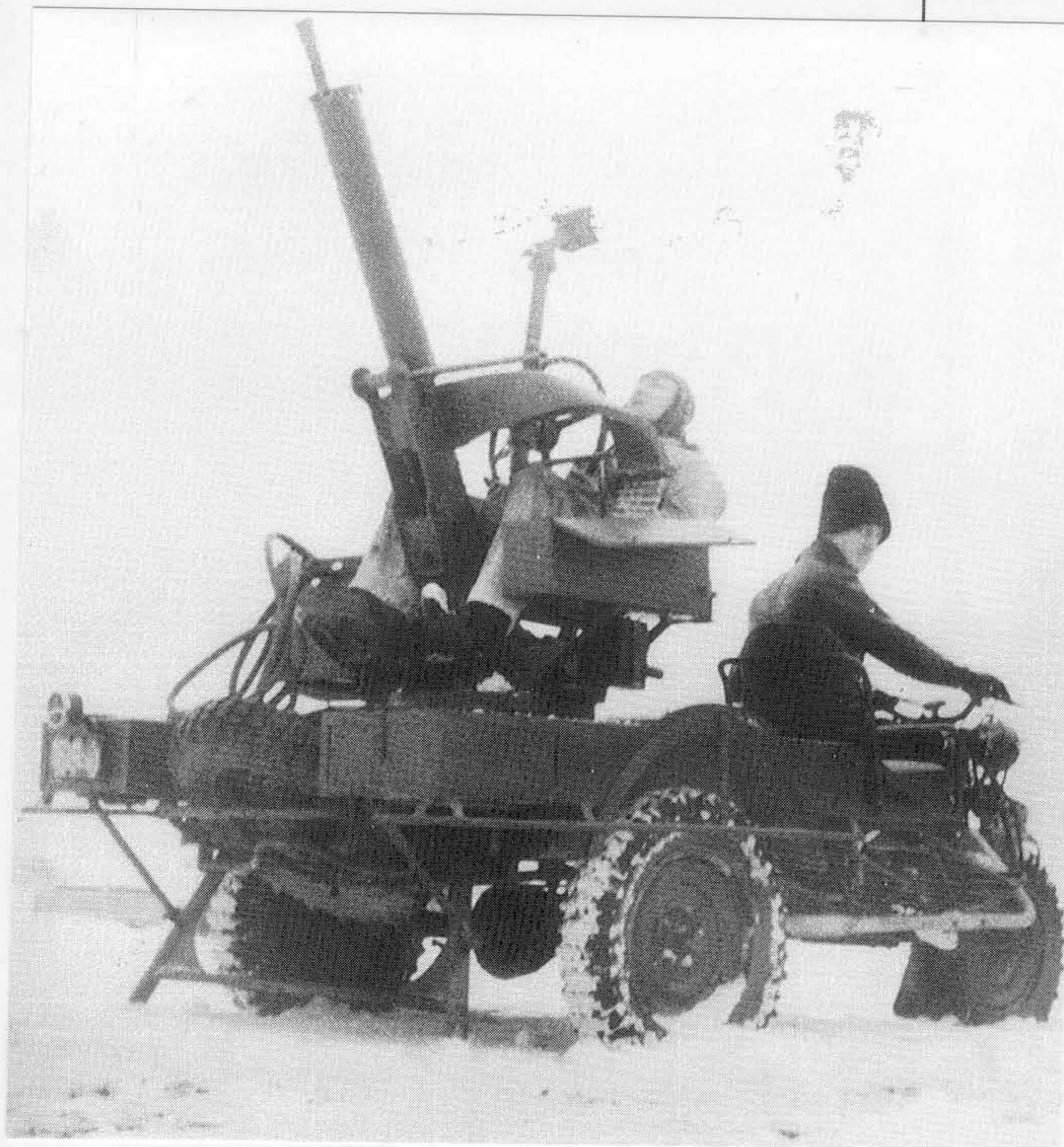
Tricar à chassis spécial commandé et prévu pour le montage d'une Mitrailleuse lourde Browning FN de 13,2 mm ou Hotchkiss de 13 mm (suivant les sources d'information) contre les avions. Le 27 février 1940, 88 unités de ce modèle ont été commandées par l'Etat-Major de l'armée belge. Les tricars n'ont pas été livrés. La guerre fut déclenchée avant..
