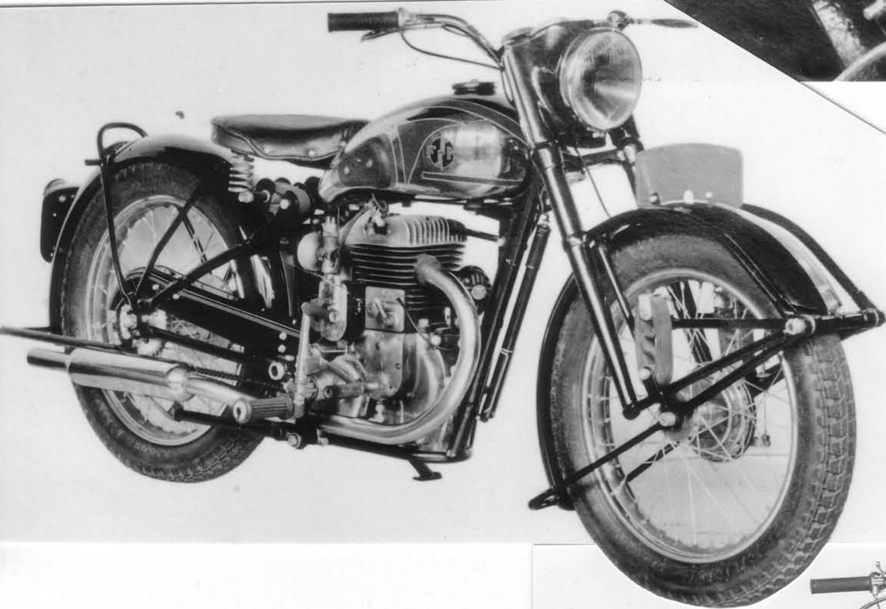
Prototype d'un modèle XIII avec compteur et commandes de phare intégré au phare.
