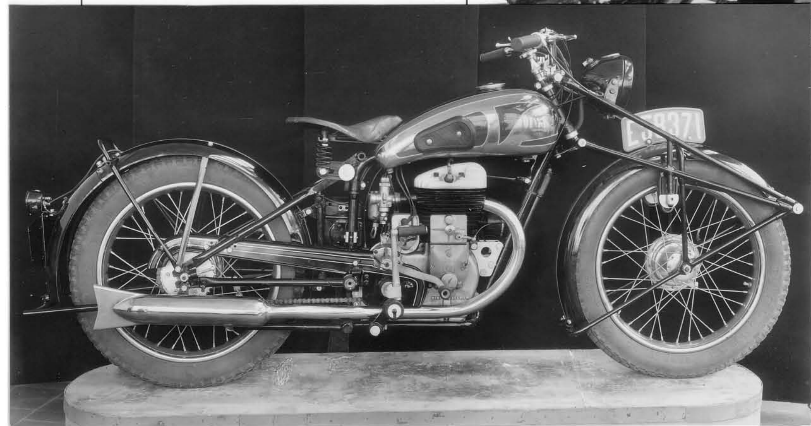
Type XIII presque dans sa version commerciale. Sur les modèles de 1947 les anneaux Neiman de la fourche avant seront remplacés par des ressorts et des biellettes, en raison de la pénurie en caoutchouc naturel. (1946)
