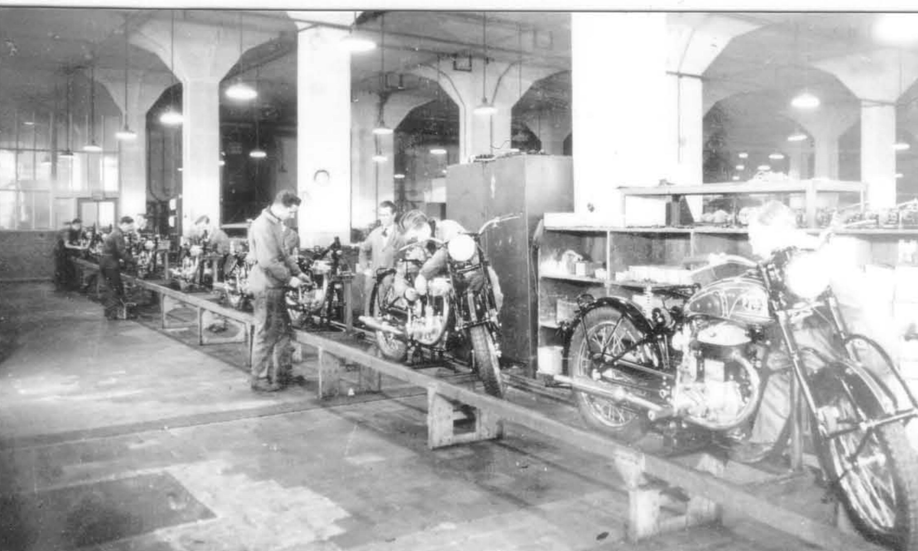
La chaîne de montage des type XIII réduite à sa plus simple expression.
