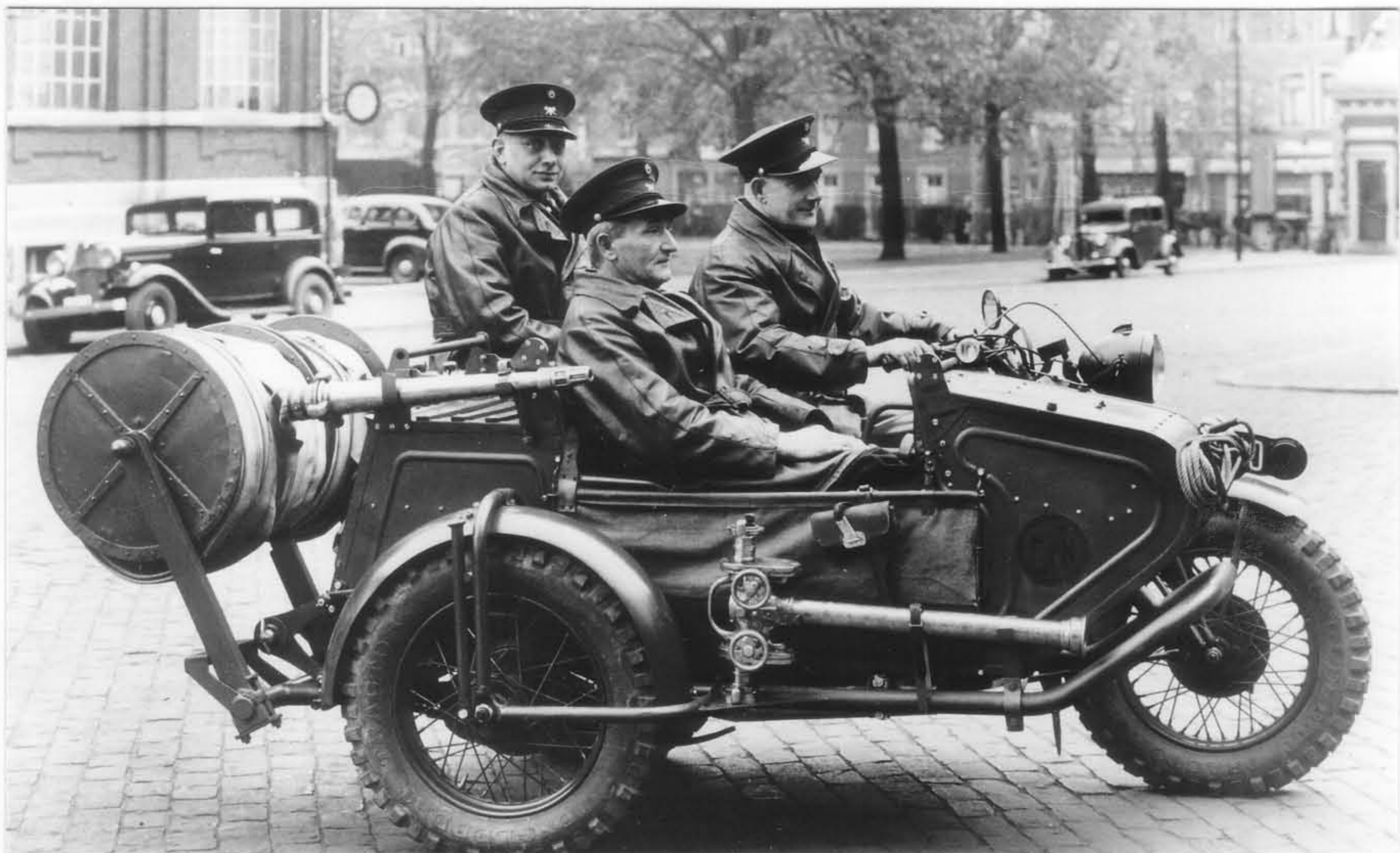
M-12 de type militaire, équipée d'un dévidoir pour les pompiers de la ville de Liège. (1er secours)
